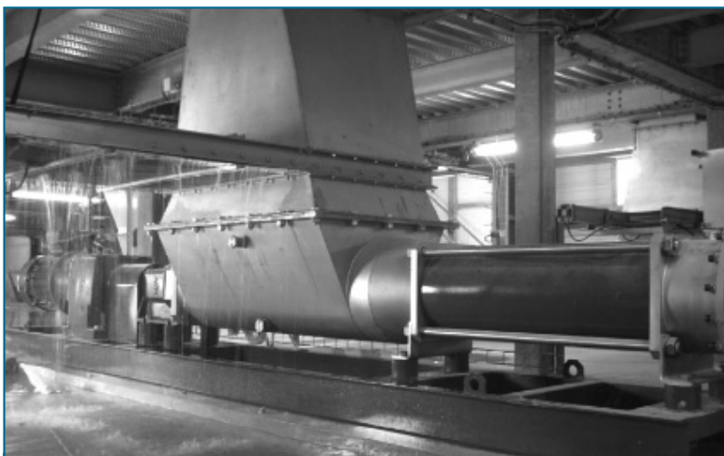
Рис. 4. Перекачивание жема винтовым насосом
